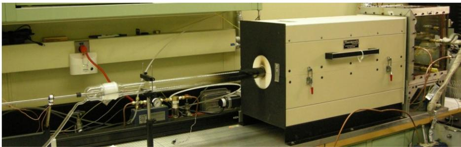
**FIGURE 2. ISO/TS 19700 Tube Furnace.**
